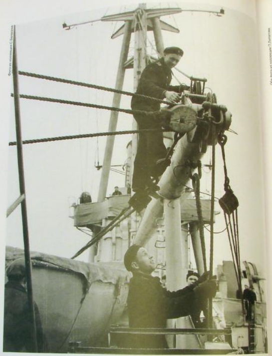
Крейсер «Киров», крепление грузовой стрелы гот-мачты по-походному, 1950-е гг.
